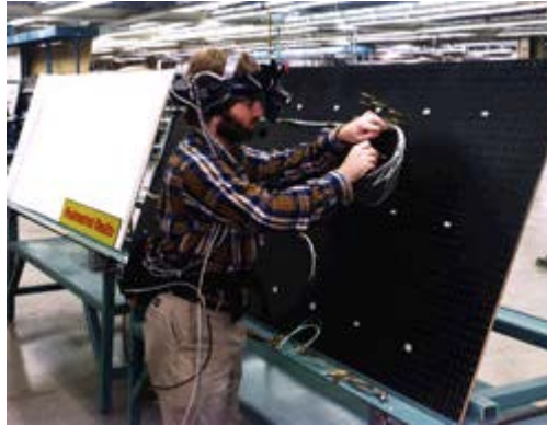
Слика 6: Adam Janin ја демонстрира апликацијата за составување на Боинг ожичување.
