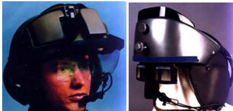
Слика 12: Два оптички дисплеи на главата HMD
