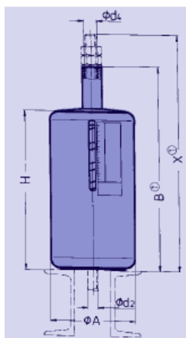
Slika 6. Vanjske dimenzije elastičnog oslonca tip 25
