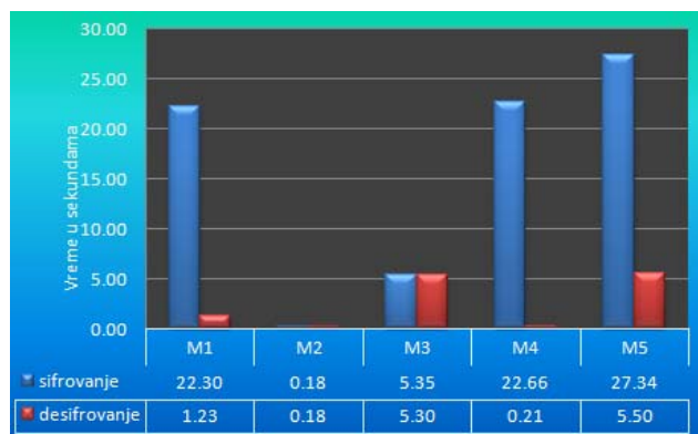
Sl 3. Dijagram sa ostvarenim brzinama AES algoritma
