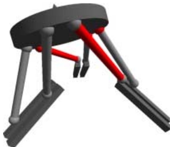
Slika 7.4 Nedozvoljeni položaj manipulatora
