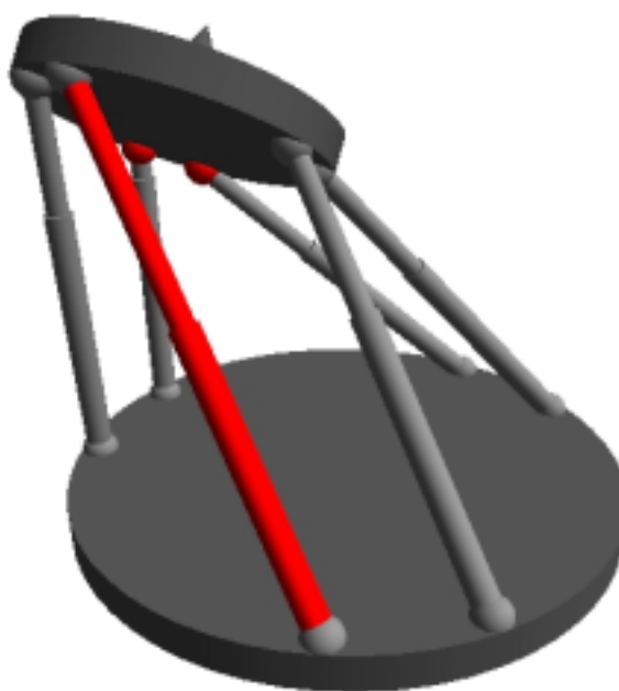
Slika 7.2 Nedozvoljeni položaj manipulatora
