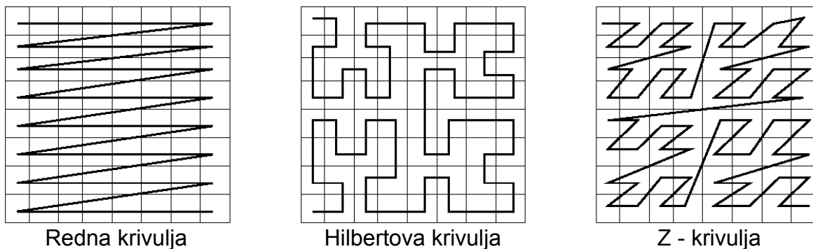
Slika 6. Krivulje za linearizaciju višedimenzionalnog prostora
